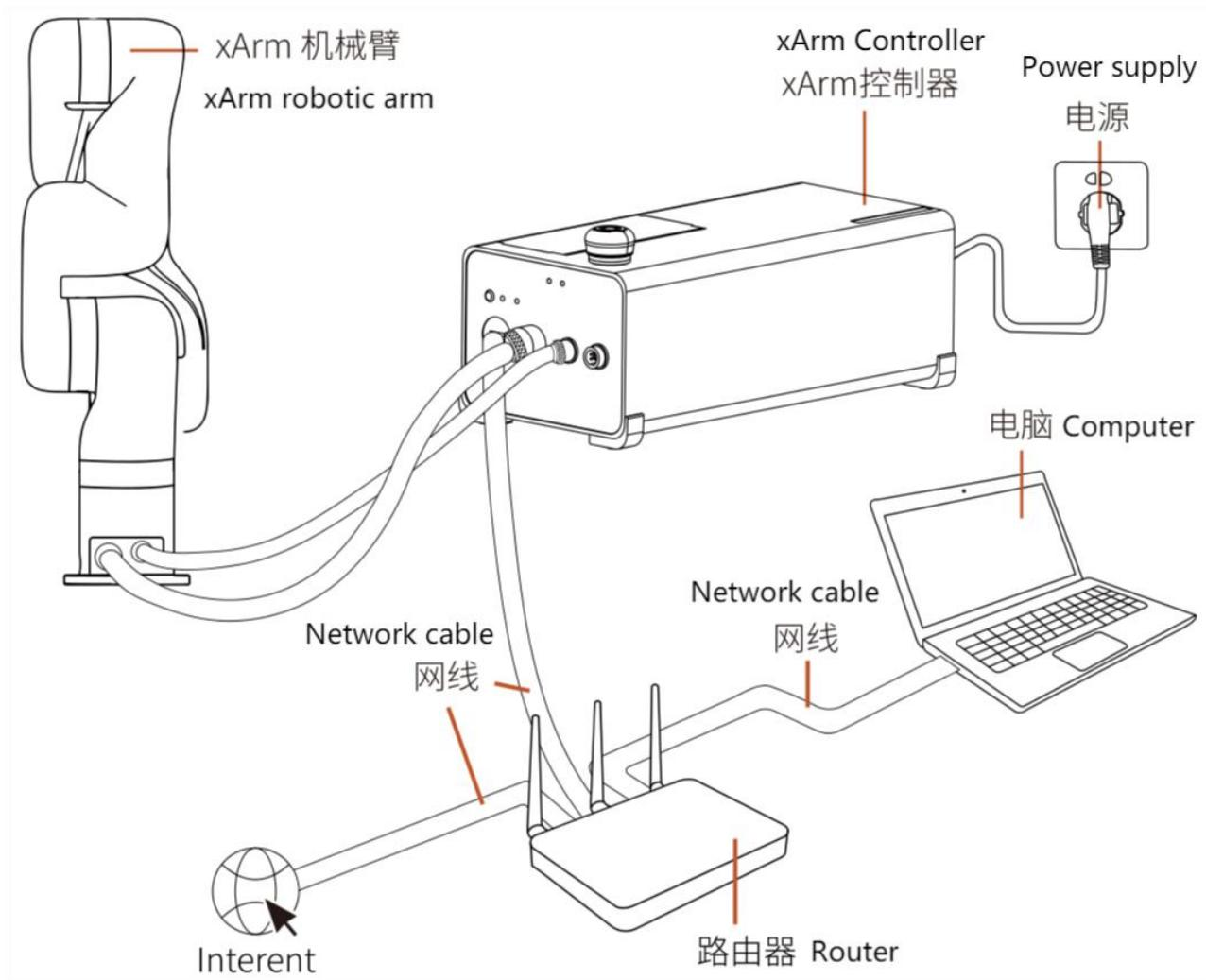
图中的电脑代表机器人底盘控制器。机械臂控制器与底盘控制器之间通过路由器进行网络通信，局域网的网段为192.168.1，机械臂控制柜旁边有出厂默认IP，这里默认IP地址为192.168.1.198。
