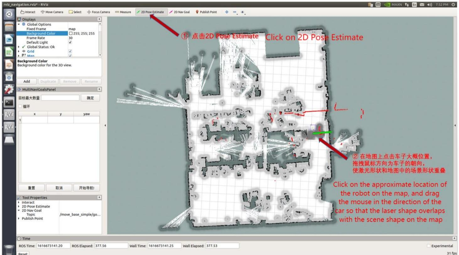
设置定位后，激光形状和地图中的场景形状已基本重合，校正完成。如下图所示
