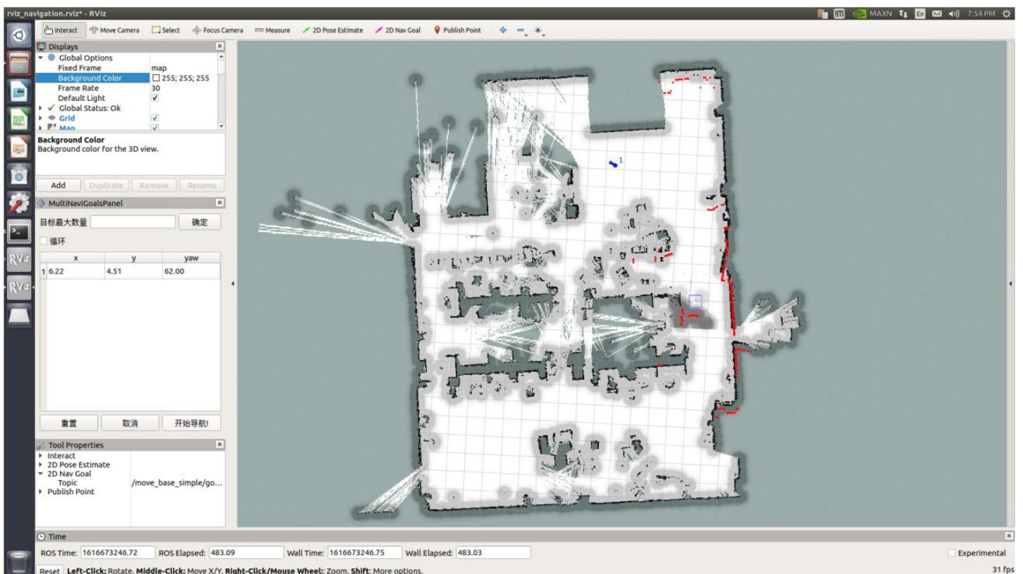
点击开始导航，地图已生成路径（绿色），将自动导航到目标点
