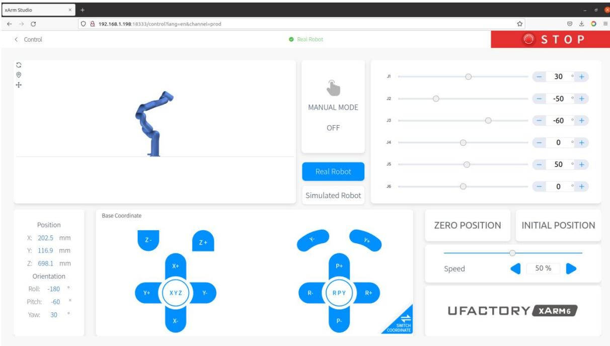
在界面中，我们可以点击MANUAL MODE按钮，使其变为ON启动手动模式，此时我们便可以来拖动机械臂运动。注意：开启手动模式之前，要配置机械臂末端工具的负载参数，默认已经配置好，用户也可以在设置页面中进行自动参数辨识。
