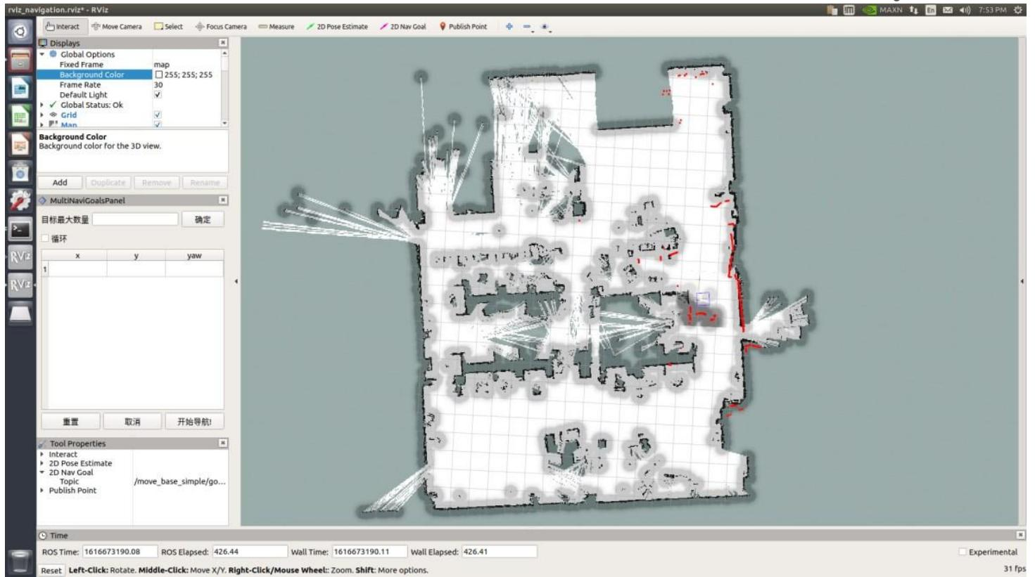
(5) 在左侧栏多点导航的插件上设置目标点，点击开始导航，切换手柄为指令控制模式。
