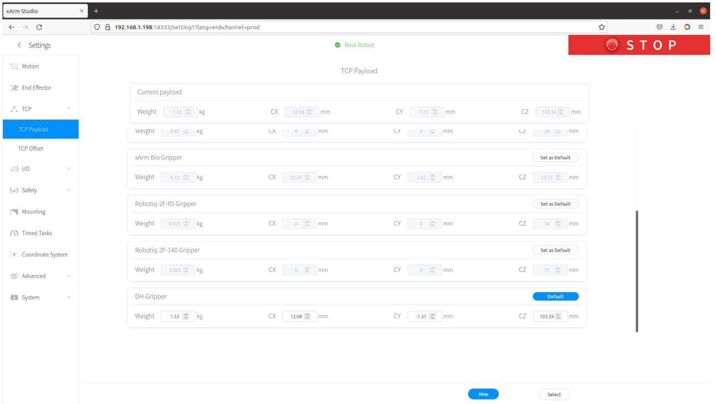
上图TCP Payload中的DH Gripper参数为自适应辨识参数，它包括了机械臂末端安装的大寰机械手爪和RealSense相机。
