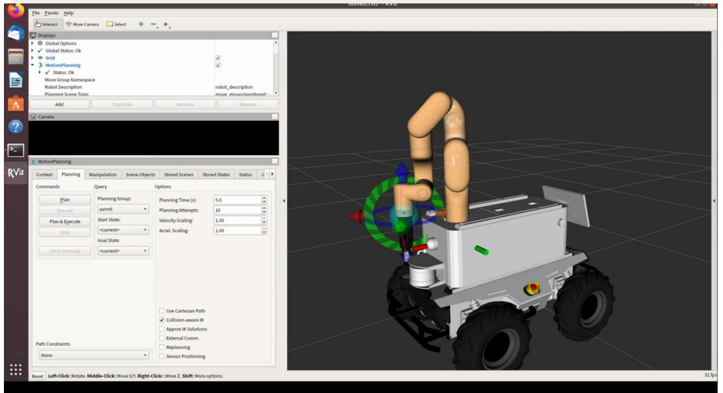
这是完整的底盘与机械臂的组合模型，我们可以拖动机械臂末端执行路径规划，此时的机械臂不会与底盘发生碰撞。
