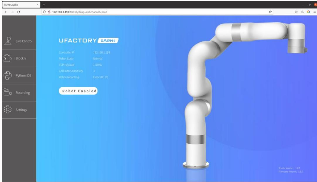
点击左侧的Live Control，进入如下图所示的机械臂实时控制界面。这里我们可以看到机械臂的状态位形、机械臂的末端位置和姿态以及每个关节的角度数据，同时我们也可以通过相应的按钮控制机械臂的每个关节进行运动，或者直接控制机械臂末端在基坐标系下的位姿。
